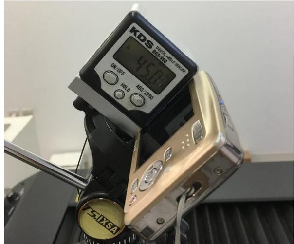
図1 角度を合わせ撮影(上図は45度) ※平行になるよう定盤上で撮影
